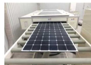
太陽光パネルのリサイクル設備
